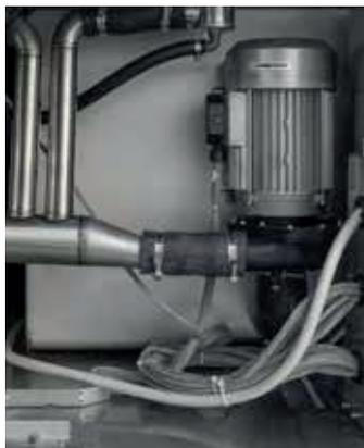
Per garantire la massima igiene della macchina, le pompe sono installate in verticale così da scaricare completamente l'acqua residua, eliminando il rischio di pericolosi ristagni.
