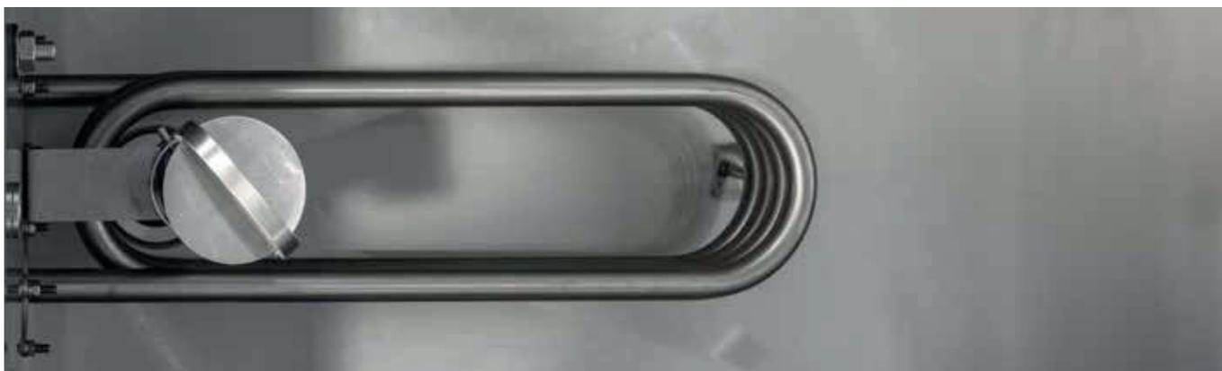
I modelli LP 1300 possono essere equipaggiati con il sistema di riscaldamento a vapore indiretto. La tecnologia a vapore permette di scaldare l'acqua di lavaggio e risciacquo tramite delle serpentine in acciaio inox per restituire condensa a 95° riutilizzabile per la produzione di nuovo vapore.
