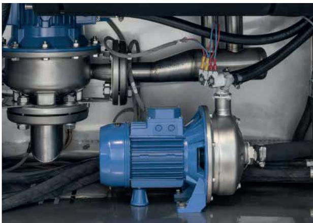
Per particolari esigenze, su tutti i modelli della serie LP, è possibile installare pompe di lavaggio in acciaio inox da 3 kW.
